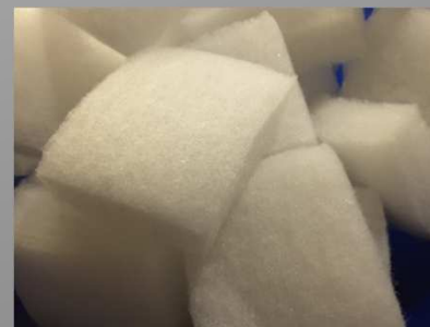
Filterelemente nach der Reinigung
